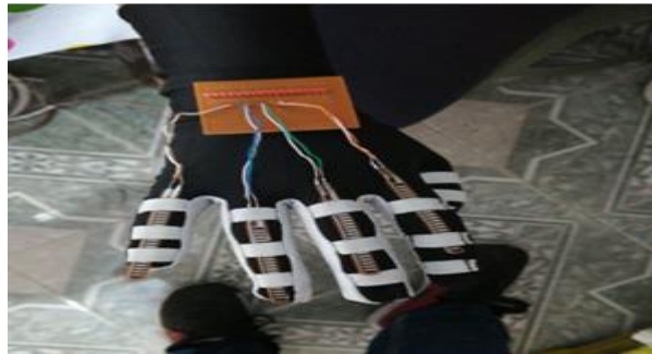
Fig. 7 Prototipo 2. Guante de licra, con sensores flexibles comerciales.
