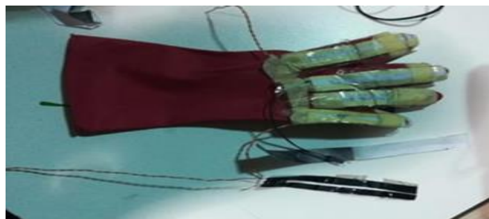
Fig. 5 Prototipo 0. Consiste en un guante de látex con sensores flexible elaborados de grafito de manera casera.
