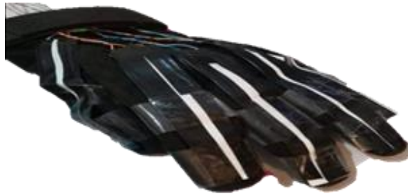
Fig. 6 Prototipo 1. Guante textil de algodón con laminillas de cobre.
